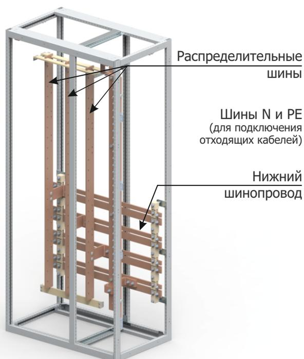
Вертикальные распределительные шины расположены в шинном отсеке, в левой части шкафа.
