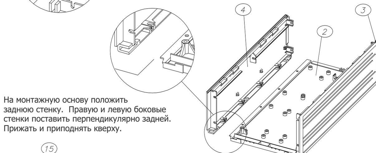
На монтажную основу положить заднюю стенку. Правую и левую боковые стенки поставить перпендикулярно задней. Прижать и приподнять сверху.
