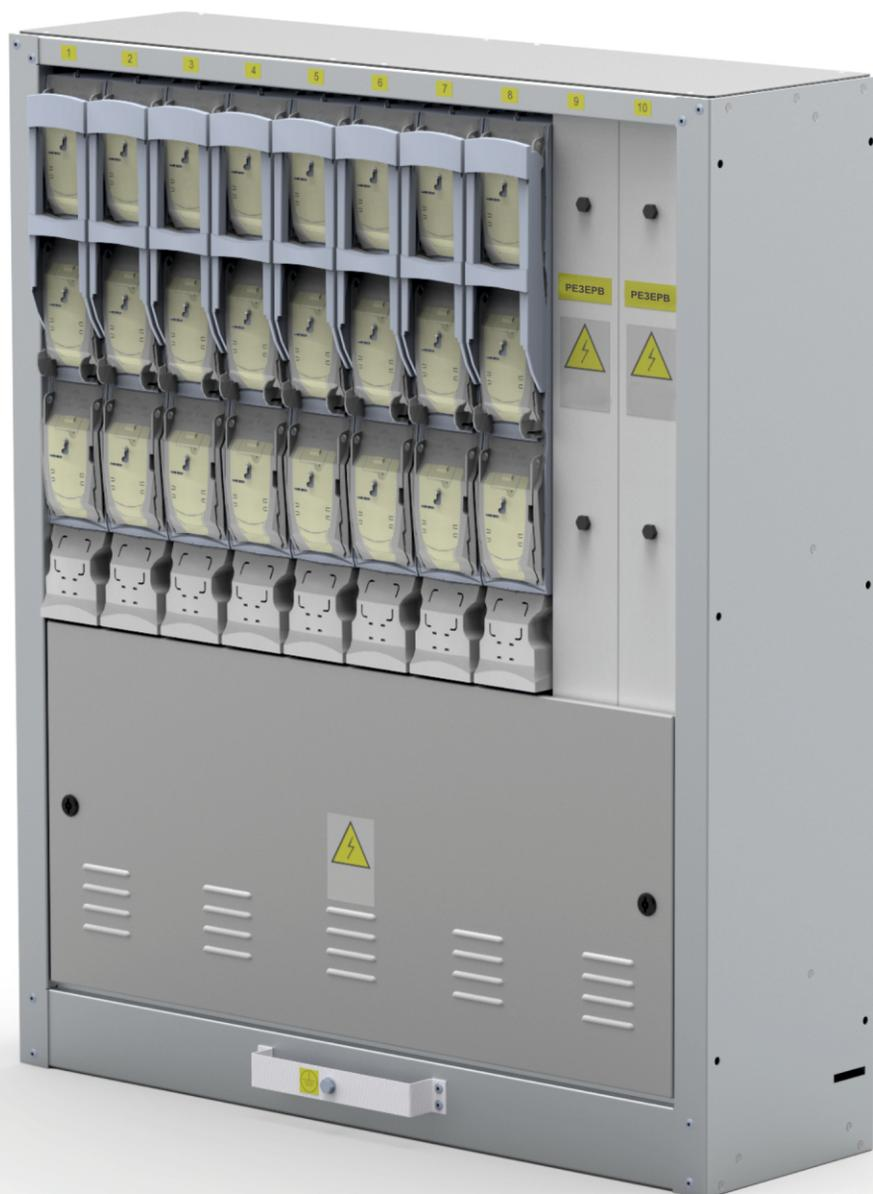
В модуле отходящих линий можно установить от 5 до 12 выключателей нагрузки с предохранителями типоразмерами от 1 до 3 разных производителей вместе с измерительными трансформаторами. Отходящие элементы можно совмещать в комплекты.
