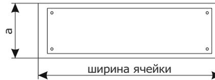
Кожух способствует введению в распределительное устройство кабелей в помещениях без кабельных каналов. Высота кожуха „а“ зависит от радиуса сгибания кабеля.
