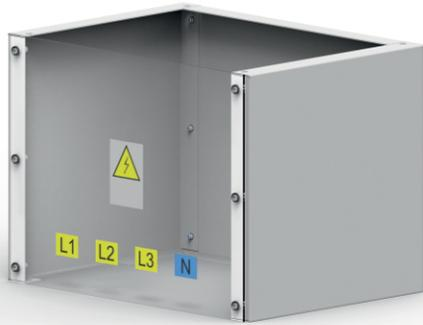
Защита вывода шинного моста из распределительного устройства. Обеспечивает степень защиты IP20 и защищает обслуживающий персонал от непосредственного контакта с открытыми элементами.
